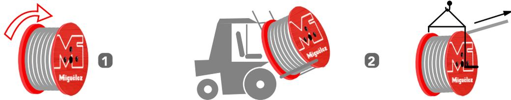
**Rodar la bobina en la dirección utilizada durante el bobinado del cable.**
