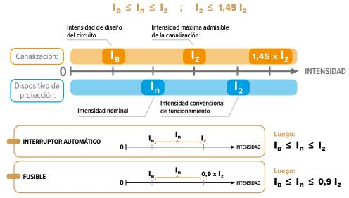
I<sub>p</sub>, es la intensidad de diseño del circuito.
