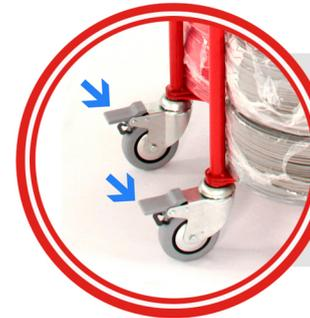
Il est constitué par deux roues avant en polyuréthane injecté et de diamètre 100mm, directionnelles et équipées d'un système de freinage, et par deux roues arrière en polyuréthane et de diamètre 200mm, non-directionnelles, **qui permettent de le déplacer sur n'importe quelle surface et d'amortir les vibrations.**
